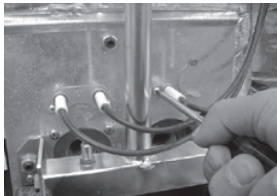
Foto P: Rimozione elettrodi di accensione e rivelazione Foto P: Desmontaje del electrodo de encendido y sonda detectora llama
