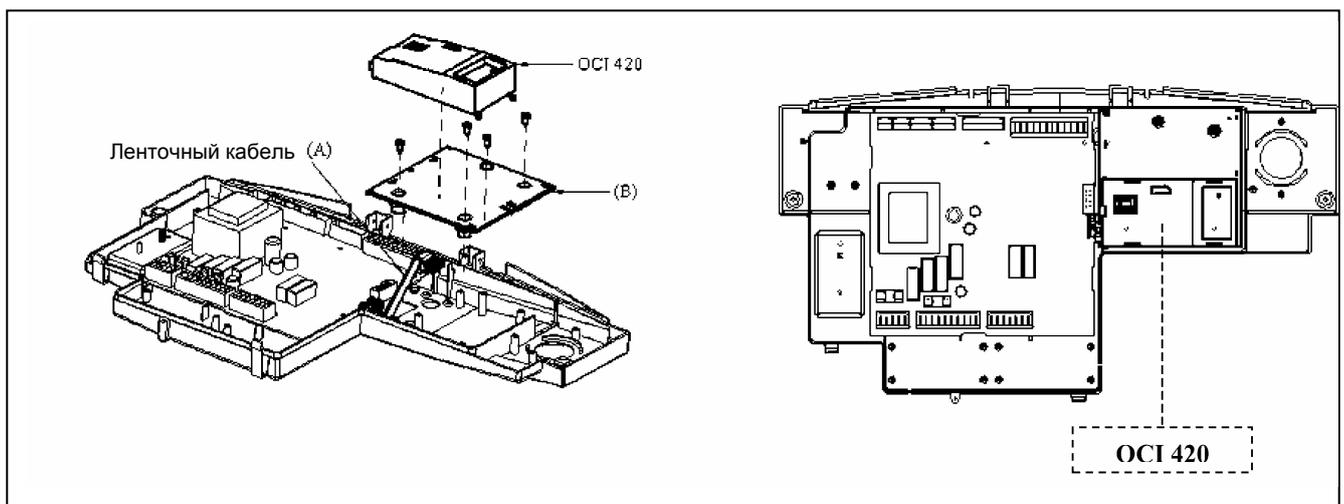
**Внимание:** Для облегчения присоединения аксессуара к электронной плате, подключайте кабель (А) к электронной плате до фиксации опорной площадки (В). Для точной установки крышки блока управления, на ней необходимо срезать два пластиковых штырька, которые расположены напротив модуля ОС1 420.
