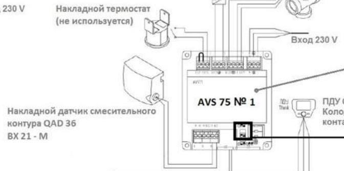
Установить адрес модуля DIP - переключателем:
